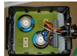
Conception et réalisation simulateur LVDT (Snecma Services)
